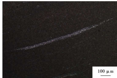
图 2 GCr15 钢铸坯 1 220 °C 7 h 高温扩散的 Φ13.494 mm 成品钢球(材料 1)碳化物带状组织
